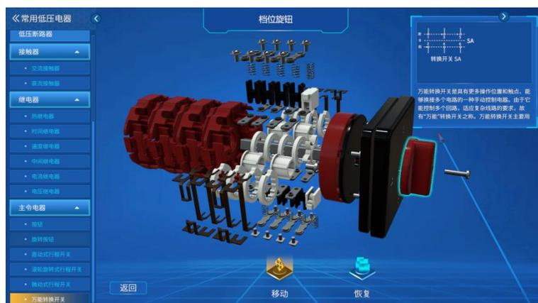
通过爆炸功能，拖拽翻转各零件，清晰展示万能转换开关内部零件组成
