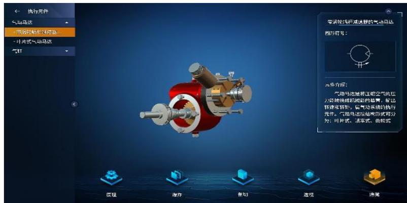
通过隐藏功能，将气动马达外部的构造隐藏，可直观展示其内部零件装配位置。
