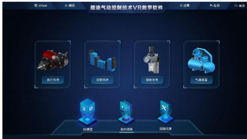
软件由 3D 模型、我的课程、回路搭建三部分构成。其中 3D 模型包含执行元件、控制元件、辅助元件、气源装置四个模块。软件包含 150 个 3D 可交互的精品模型资源，内置 11 个回路搭建任务，覆盖 90% 以上的液压与气动技术等基础教学知识点，通过液压回路搭建，强化理论知识学习。
