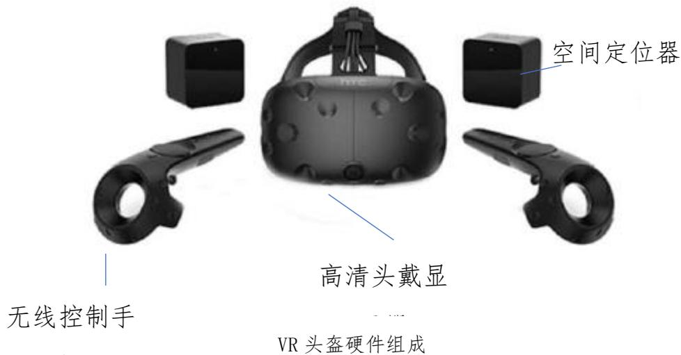
**高清头戴显示器：**参与者进行实操时戴在头上的一种显示外设，并通过转动头部的角度，来调整视角的方向，并以刷新率高达每秒 90 帧图像，带入沉浸式场景当中。
