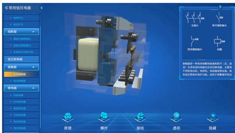
通过透视/隐藏功能，将元件外部的构造透视/隐藏，直观展示其内部零件装配位置
