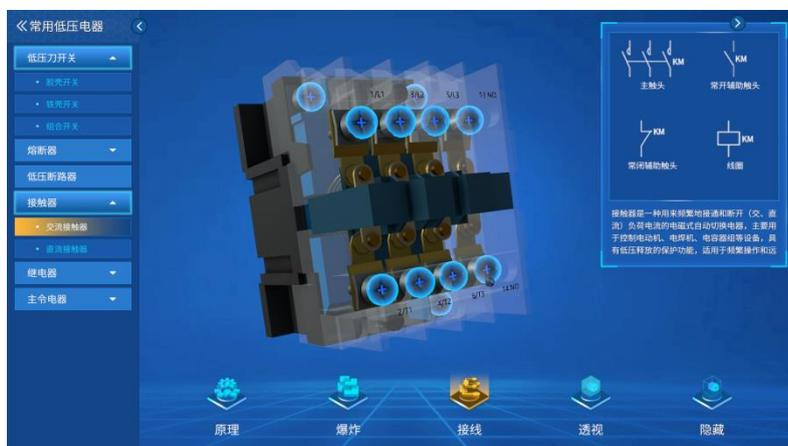
通过接线功能，直观展示元件关键接线点的名称和位置，增加学生对元件结构认知和理解
