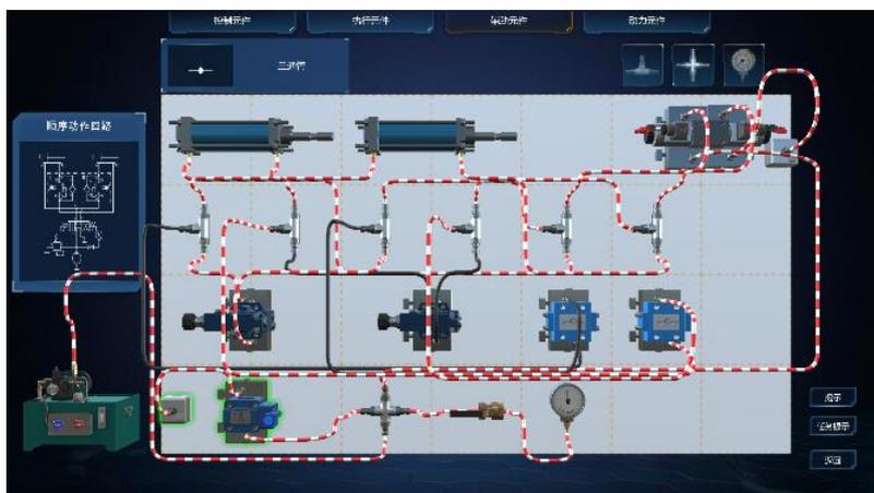
教师可根据教学需求，在液压实训模块进行液压回路的任务搭建。
