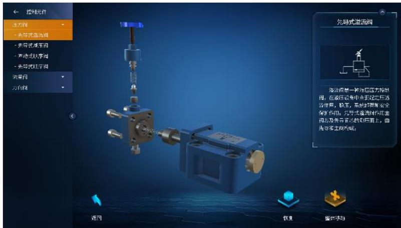
直观清晰展示先导式溢流阀的内部构造是由先导和主阀构成。
