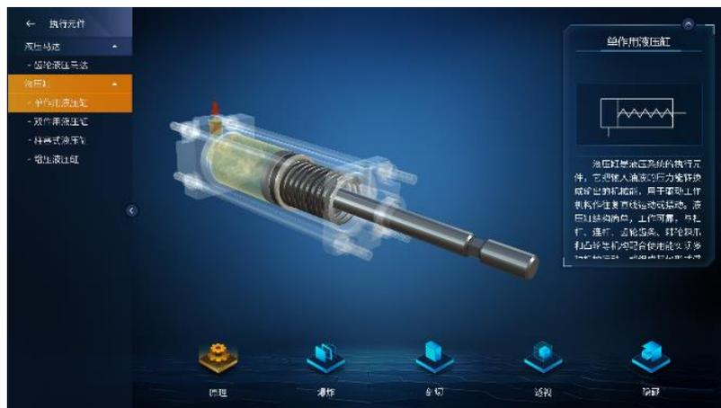
通过三维动画，动态立体展示单作用液压缸把压力能转换成机械能的过程。
