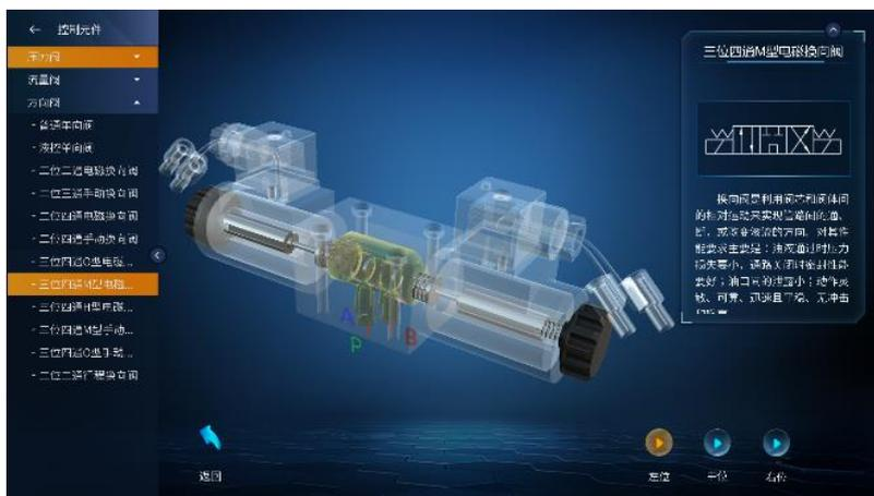
构建虚拟场景，直观形象呈现换向阀利用阀芯和阀体间相对运动改变液流方向的过程。
